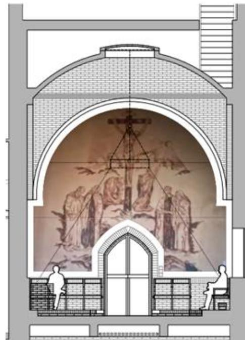
Fehlstellen im Klinkersockelbereich werden denkmalgerecht mit materialgleichen Ziegeln geschlossen und schonend gereinigt, ebenso das Gewölbe. Die bauzeitlichen Stuhlreihen werden neu geordnet und aufgearbeitet.
